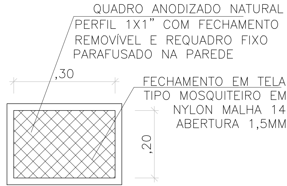
DETALHE 04 — VISTA EXTERNA ESC. 1/25 DETALHE DO QUADRO C/ TELA MOSQUITEIRO
